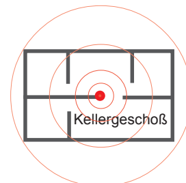
Bild 27 Hausgrundriss, Funksender (roter Punkt) und Ausbreitung der Funkwellen
